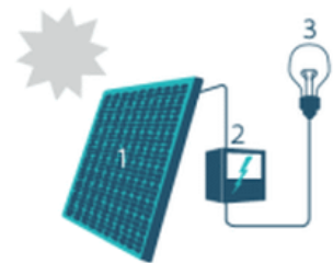
1. Zonnepaneel | 2. Omvormer | 3. Elektrische toestellen
